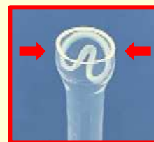
参考不具合写真 リング潰れ状態
