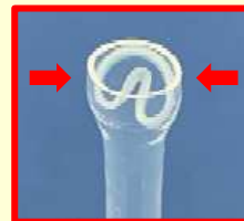
参考不具合写真 リング潰れ状態
