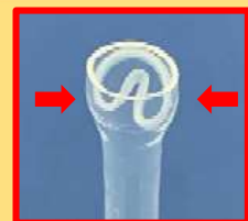
参考不具合写真 リング潰れ状態
